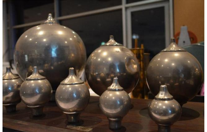
Abb. 5 Kugel-Resonatoren von Helmholtz
