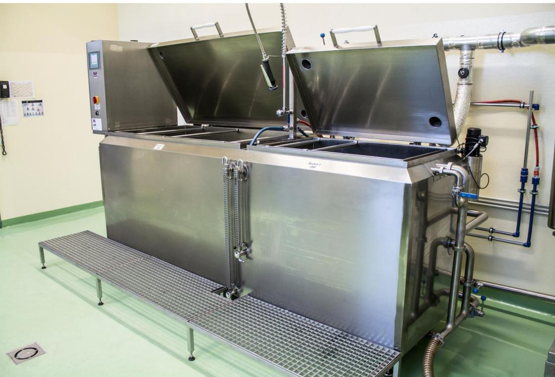
**Abb.: Knochen-Mazerationsanlage mit 2 individuell regelbaren Prozess-Kammern.**
