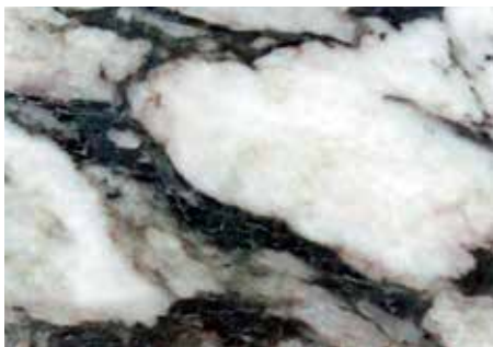
Links: Anhydrit-Knollen (weiss) von Ton umgeben (grau) aus dem Tafeljura. Mitte: Dünnschliff von Anhydrit aus dem Tafeljura in polarisiertem Licht. Rechts: Anhydrit (weiss) und Ton (grau) durch Darübergerleiten von Gesteinen des Faltenjuras ausgewalzt; dünne Lagen entsprechen ehemaligen Knollen (Bilder: Departement Umweltwissenschaften).
