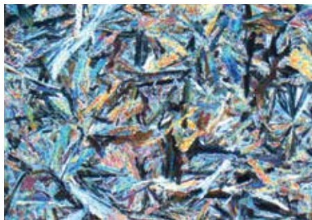
Links: Anhydrit-Knollen (weiss) von Ton umgeben (grau) aus dem Tafeljura. Mitte: Dünnschliff von Anhydrit aus dem Tafeljura in polarisiertem Licht. Rechts: Anhydrit (weiss) und Ton (grau) durch Darübergerleiten von Gesteinen des Faltenjuras ausgewalzt; dünne Lagen entsprechen ehemaligen Knollen (Bilder: Departement Umweltwissenschaften).
